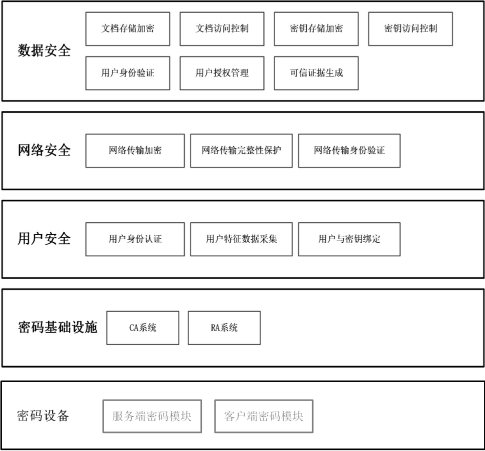
图 5-4 电子合同密码技术框架图-安全角度
