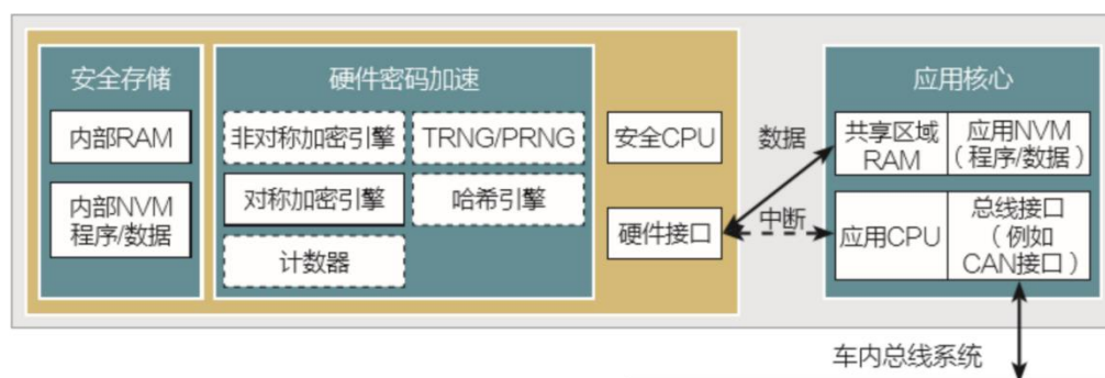
图 4-5 EVITA 关于 HSM 的基本结构
