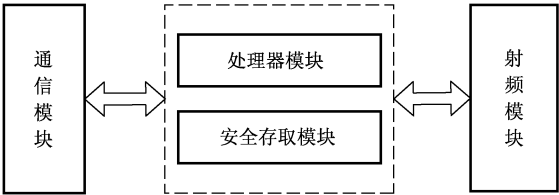
图 1 读写器基本结构
