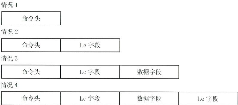
图 3 命令 APDU 的 4 种结构
