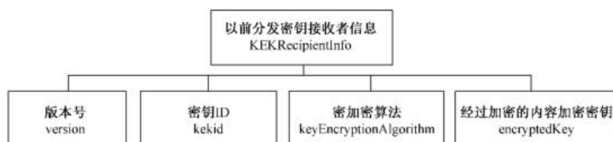
图 6 KEKRecipientInfo 类型结构框图
