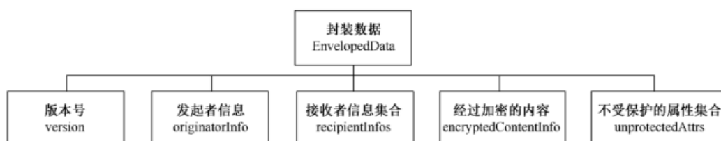
图 3 EnvelopedData 类型结构框图
