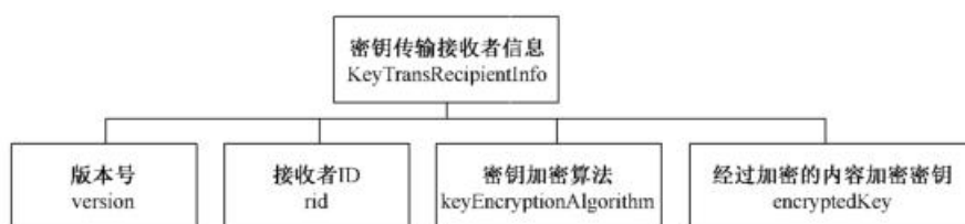
图 4 KeyTransRecipientInfo 类型结构框图
