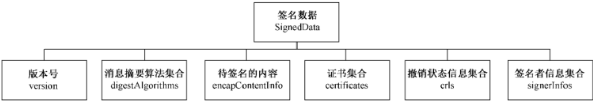
图 1 SignedData 类型结构框图
