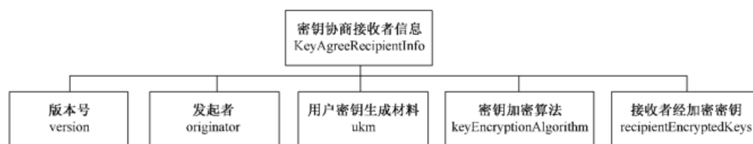
图 5 KeyAgreeRecipientInfo 类型结构框图
