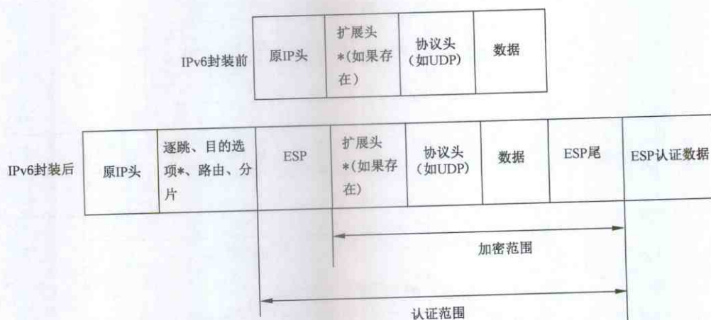
图 34 IPv6 的 ESP 传输模式
