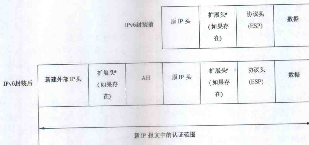
图 31 IPv6 的 AH 隧道模式
